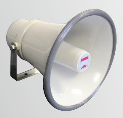
Leichter Druckkammerlautsprecher für den rauhen Einsatz in lauten Umgebungen. Witterungsbeständig nach IP 66. Gute akustische Eigenschaften, hervorragend geeignet für Industrieanlagen und im Außenbereich. Universal Montagehalterung mit Edelstahlschrauben im Lieferumfang enthalten.
