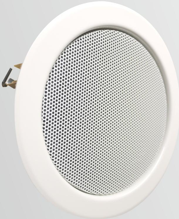
Leicht und schnell zu installierender 22 cm Deckeneinbaulautsprecher in pulverbeschichteter Ganzmetallausführung. Zweiteilig mit Bajonettverschluss Abdeckgitter und "snap in" Deckenmontagering. 6 Watt Nennleistung. Hoher Wirkungsgrad, 95 db/1W/1m. Frequenzgang 80 Hz bis 18 kHz für hohe Sprachverständlichkeit bei gleichzeitig natürlicher Musikkwiedergabe. Empfindlichkeit durch 3 Leistungsabgriffe (6,3 und 1,5 W) anzupassen. Anschluss mit schraublosen Klemmkontakten. Zubehör: Feuertopf FD-6
