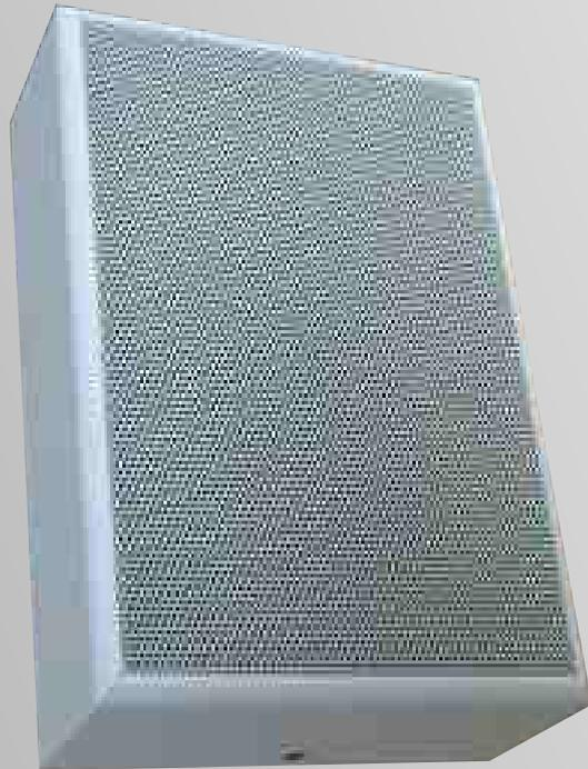
Leichter Wandlautsprecher im weissen MDF- Gehäuse, Kunststoff beschichtet in RAL9010 weiss. Frontgitter aus rostfreiem Zincor. Hoher Wirkungsgrad, 96 db/1W/1m. Frequenzgang 90 Hz bis 18 kHz für hohe Sprachverständlichkeit bei gleichzeitig natürlicher Musikwiedergabe. Empfindlichkeit durch 3 Leistungsabgriffe (6W,3W und 1,5 W) anzupassen.
